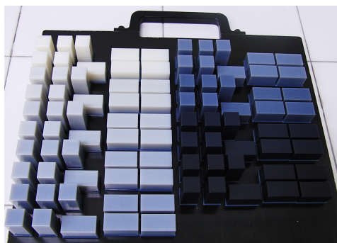
10. ábra. Fémhab nyomóvizsgálata és Polyjet technológiával készült nyomópróbatestek
