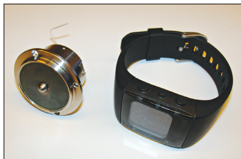
3. ábra. Az intelligens erőmérő cella és a karóraként is funkcionáló terhelést visszajelző eszköz
