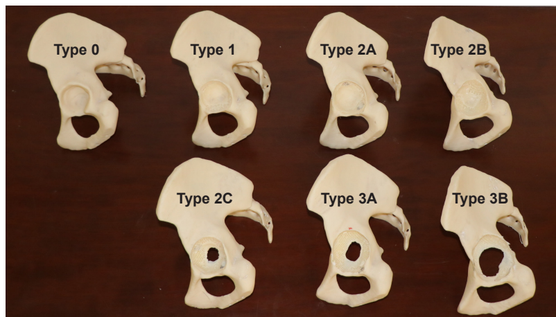
6. ábra. A 3D nyomtatással készült medencemodellek.
