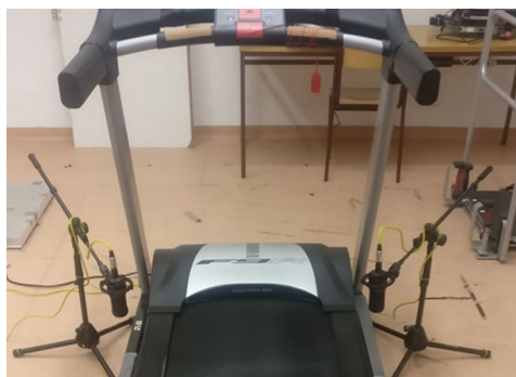
1. ábra. Futópados hangfelvétel mérési elrendezésének illusztrációja
