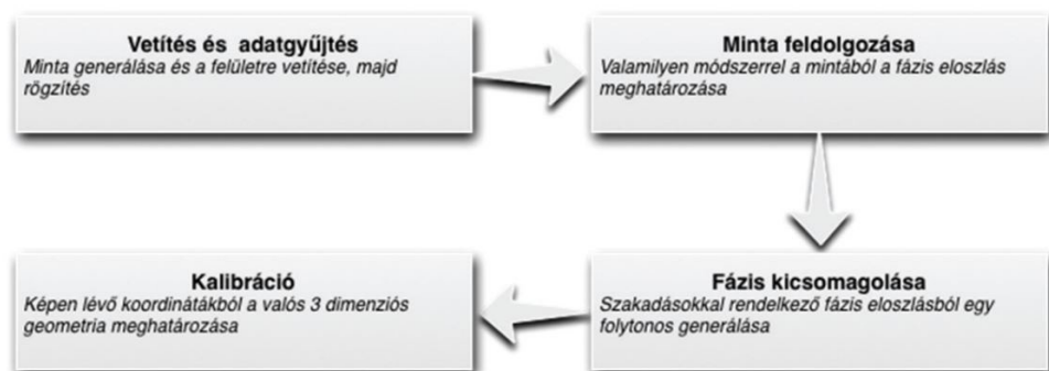
3. ábra. A profilometriai mérési folyamat végrehajtásának általános lépései. 20
