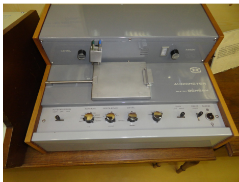
2. ábra. A Békésy-féle audiométer, a diósi Rádió és TV múzeumban van kiállítva
