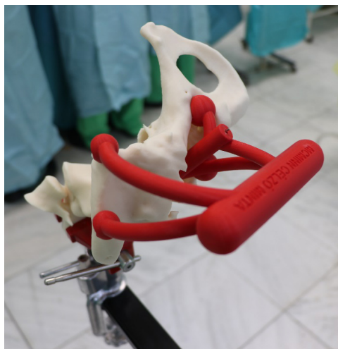
5. ábra. ABS alapanyagú, FDM technológiával nyomtatott félmedence, a célzóval
