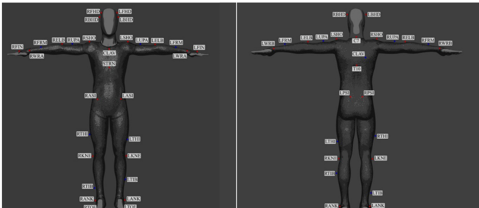
3. ábra. A 39 pontos biomechanikai modell, pirossal az anatómiai, kékkel az oldaljelölő pontokat jelölve
