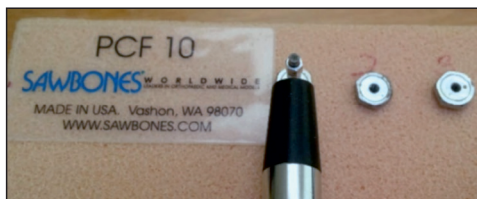
4. ábra. PCF10-es blokkba 17 ültetett egyszerűsített implantátumok stabilitás mérése Osstell® készülékkel 19
