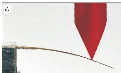
2. ábra. a) A Weberék által használt befogási rendszer: a nyomófej és a nyomófejbefogó között egy acéllemez teremt kapcsolatot, amelyre nyúlásmérő bélyeg van rögzítve; b) Az általunk alkalmazott befogási rendszer; c–d) A toll a hajlítókísérlet kezdetén és végén
