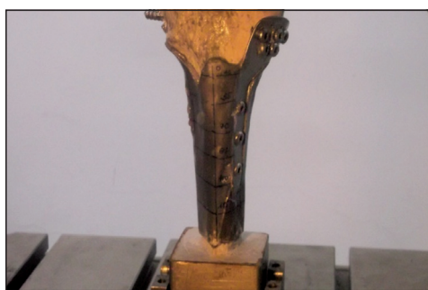
6. ábra. Feszültségoptikai vizsgálat, támasztólemezrel
