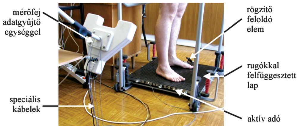
1. ábra. Az ultrahangalapú, hirtelen irányváltoztatási teszt elrendezése
