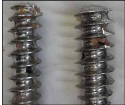
2. ábra. A hagyományos csavarok menetprofilja (szakítóvizsgálat után)
