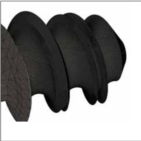
6. ábra. A csavar végén alkalmazott sűrített végelem háló (duplex modellen bemutatva)
