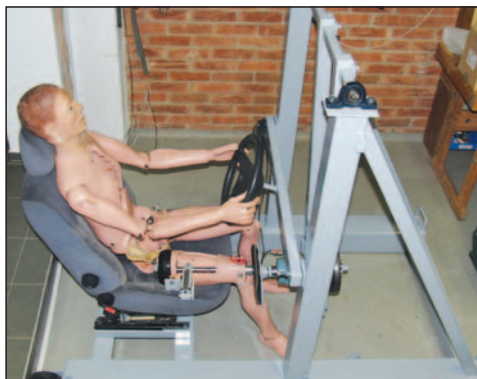
10. ábra. A csípőprotézis sérüléseit modellező rendszer
