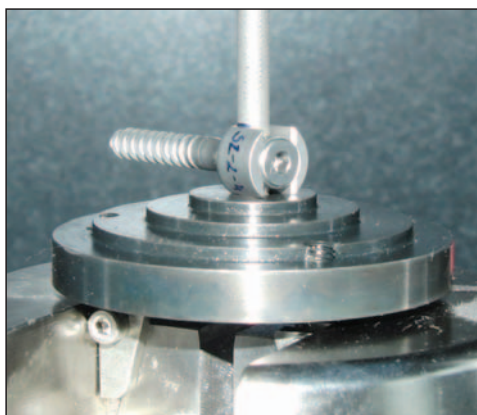
13. ábra. Gerincimplantátum és a rúd kapcsolatának stabilitásvizsgálata
