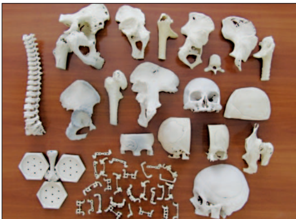
5. ábra. ZPrint 310 háromdimenziós nyomtató (a) és néhány, a sebészi célú alkalmazása során gyártott modell (b)
